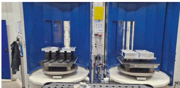
Rüstplätze für unterschiedliche Aufspannungen. Bild: Liebherr
