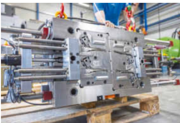
Mit dieser Spritzgießform fertigt Gardena vier Griffkomponenten in einem Zug. Bild: Maschinenfabrik Berthold Hermle AG
