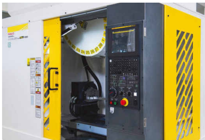
Das Bearbeitungszentrum Robodrill \alpha -D28LiB5ADV Plus Y500 bietet ein Werkzeugwechselsystem mit 28 Werkzeugplätzen.
