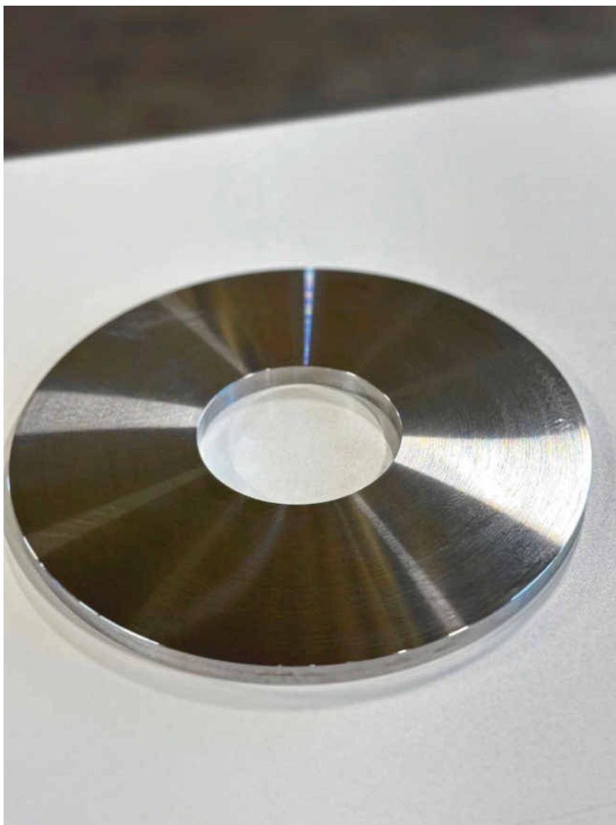
CNC Präzision Lange fertigt unter anderem Fassungen (Rohteil) aus nichtrostendem, martensitischem Stahl. Bild: H&V
