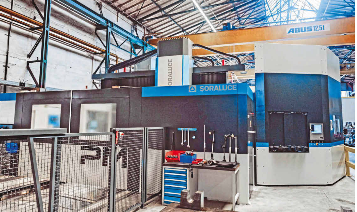
Arbeitspferd: Das Portalfräsbearbeitungszentrum PM 4000-2T mit Doppeltisch von Bimatec Soraluce ist das Kernstück der mechanischen Bearbeitung des Alstom-Werks in Netphen. Bild: onemorepicture für Bimatec Soraluce
