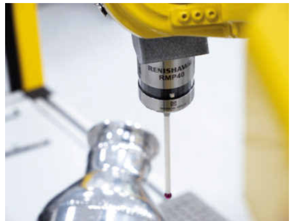
Werkstückmessung mittels eines in sechs Freiheitsgraden kalibrierten Funkmesstaster am Fanuc Roboter
