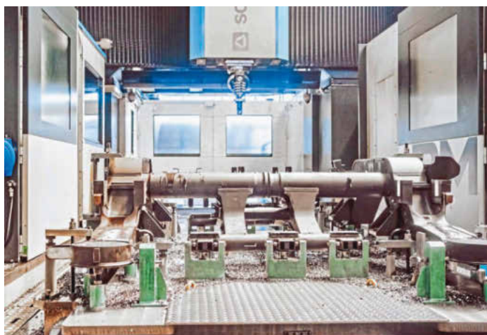
Dank der zwei unabhängig verfahrbaren Tische mit je 4000 x 3000 mm kann das Aufspannen in der Nebenzeit vorgenommen werden, ohne die Bearbeitung auf dem anderen Tisch unterbrechen zu müssen. Bild: onemorepicture für Bimatec Soraluca
