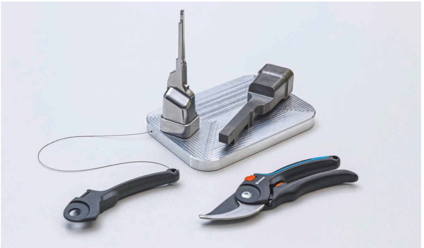
Oben rechts liegt der Kern, wie ihn die HMG an S&S Werkzeugbau zur finalen Bearbeitung (oben links) liefert. Vorne im Bild sind das gegossene Griffelement und die montierte Gartenschere zu sehen. Bild: Maschinenfabrik Berthold Hermle AG
