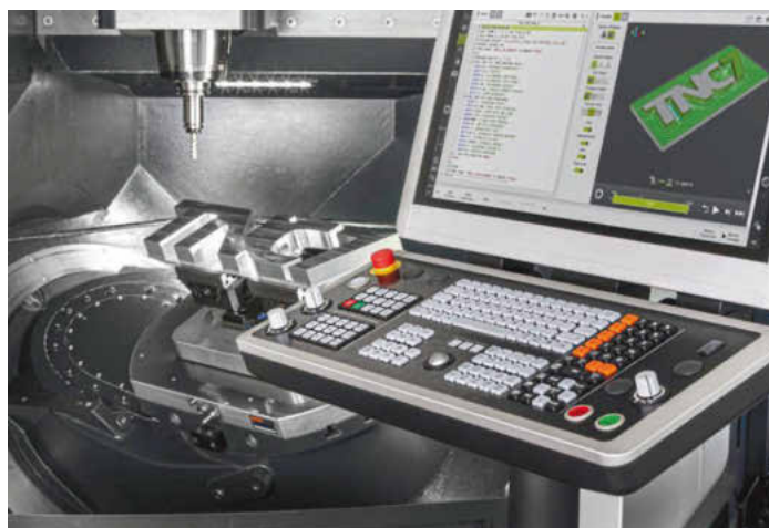
Die vollintegrierte TNC-Komponenten- und -Prozessüberwachung kommt ohne zusätzliche Sensorik aus. Sie erkennt Abweichungen von der Referenzbearbeitung zuverlässig und sorgt für eine gesicherte Prozessqualität. Bild: Heidenhain
