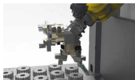
Greifer für Futterteile – also für Werkstücke, die im Futter gespannt werden – im Einsatz. Bild: Studer
