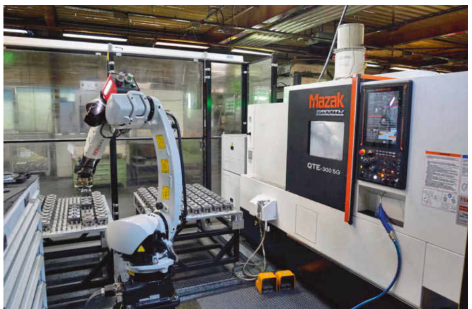
Durch die Roboterautomatisierung ist die QTE hochproduktiv. Bild: Mazak
