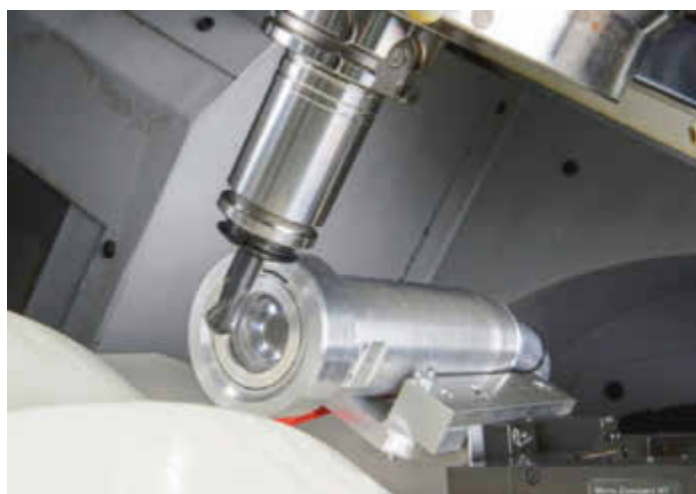
Ein widerstandsfähiges Gehäuse mit Sperrluftfunktion schützt das empfindliche Mikroskop.
